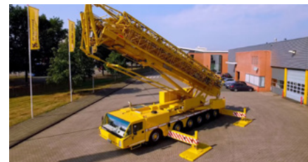
De semi-elektrische hijskraan van Spierings Kranen (foto: Spierings Kranen)
