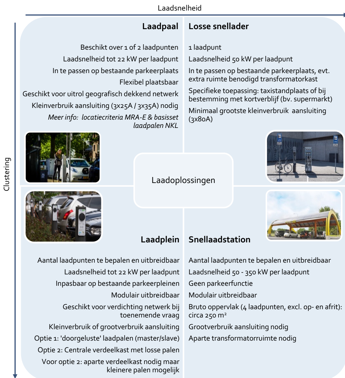
Figuur 1: Overzicht laadoplossingen met basis kenmerken gerangschikt a.d.h.v. criteria laadsnelheid en clustering
